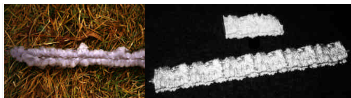
Abb. 4: Eisstück, Positivform und Windkanalmodell des Eisansatzes der INVENTUS.
