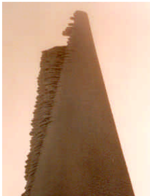
Abb. 1: Rotorblatt mit Eisansatz. Fig. 1: Ice accretion at leading edge (Foto: Kranz)
