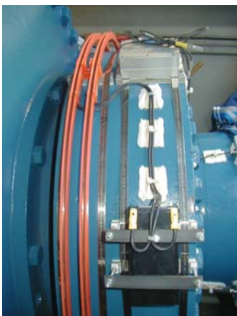
Abb. 1: Montage des Lastkollektivsammlers auf dem drehenden System. Links die Schleifringe zur Stromversorgung der Pufferbatterie, oben der Lastkollektivsammler, unten das Batteriepaket. Das mitdrehende GSM-Modem ist nicht im Bild. Fig. 1: Assembly of the field computer at the rotating system. Left side showing the slip rings for the power supply, at the top the field computer is shown, at the bottom the buffer battery. The GSM modem is not shown on the picture.
