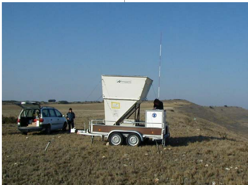
Abb. 2: SODAR Messung in Nordspanien Fig. 3: SODAR measurement in the North of Spain Fig. 3: Medición SODAR en el Norte de España
