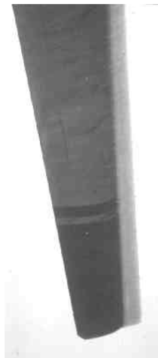
Abb. 1: Vereiste Rotorblattnase aus [1]. Fig. 1: Iced rotor blade leading edge [1].
