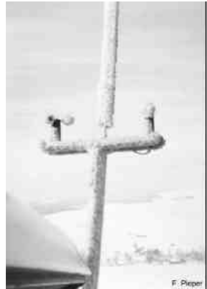
Abb. 11: Windmeßgeber der Betriebsführung unter Vereisungsbedingung Fig. 11: Iced wind measurement sensor of supervisory system (Foto: F. Pieper)
