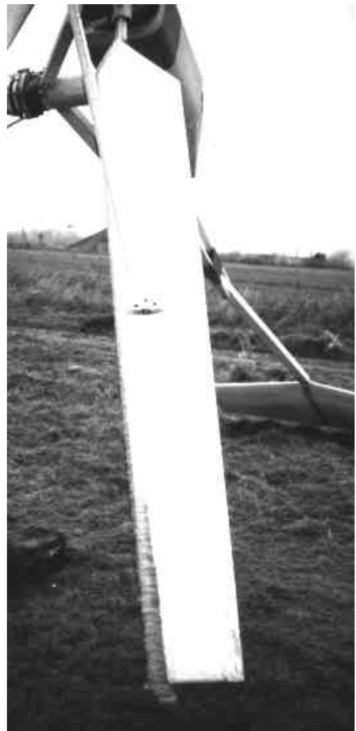
Abb. 3: Rotorblatt der INVENTUS mit Eisansatz vom 19. Januar 96 Fig. 3: Iced rotor blade of INVENTUS
