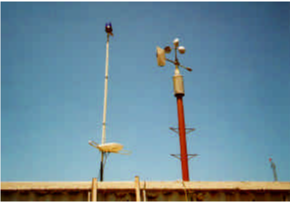
Abb. 2: Anemometer der Langzeitmeßstation Met. Istasyonunun ölçüm aleti
