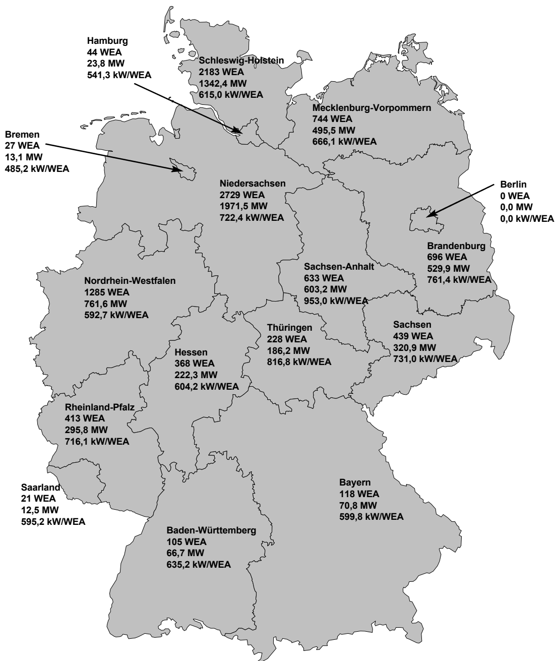
Abb. 3: Regionale Verteilung der Windenergienutzung in Deutschland, Stand 30.06.2001. Fig. 3: Regional distribution of wind energy utilisation in Germany, status 30.06.2001.
