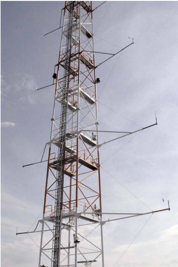
Abb.:3: Auf der im Bild linken Südost-Seite des Windmessmastes befinden sich die Schalenstern-Anemometer, rechts werden abwechselnd Windfahnen und Ultraschall-Anemometer eingesetzt. Durch Anklappen der abgespannten Ausleger lassen sich die Geräte warten und gegebenenfalls ersetzen.
