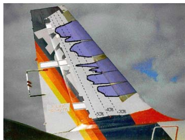
Abb. 2: Airbus A320 Seitenleitwerk mit Grenzschichtabsaugung [1] (grau unterlegte Fläche zeigt die laminare Grenzschichtströmung) Fig. 2: Airbus A 320 vertical tail with boundary layer suction (the grey marked area shows the laminar zones)
