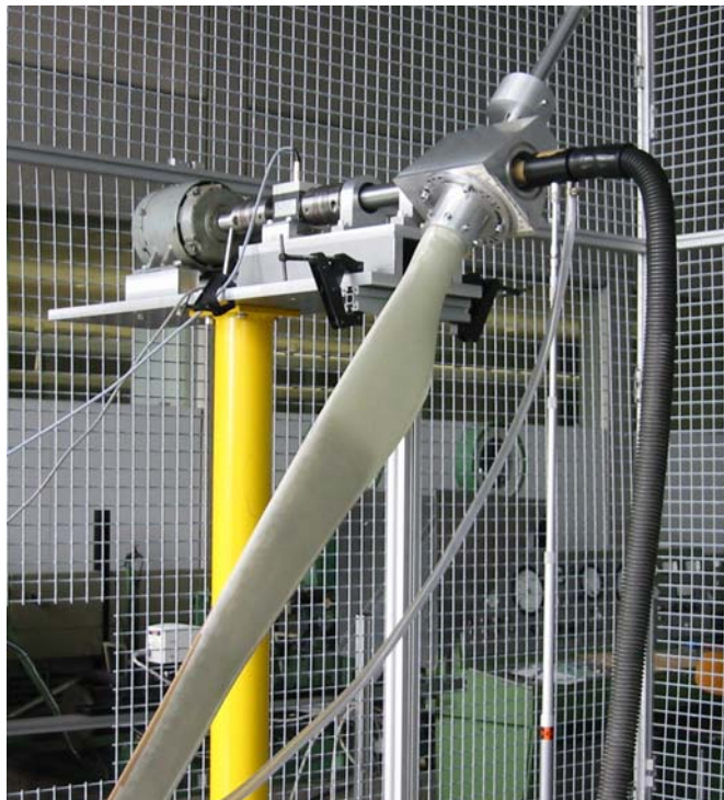
Abb. 5: Einblatt Rotor mit Versuchsanlage Fig. 5: One blade experimental wind turbine
