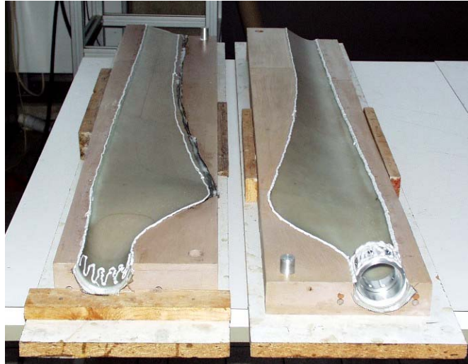
Abb. 4: GfK - Flügelhalbschalen vor dem Zusammenfügen Fig. 4: Fiber glass half shells before agglutination
