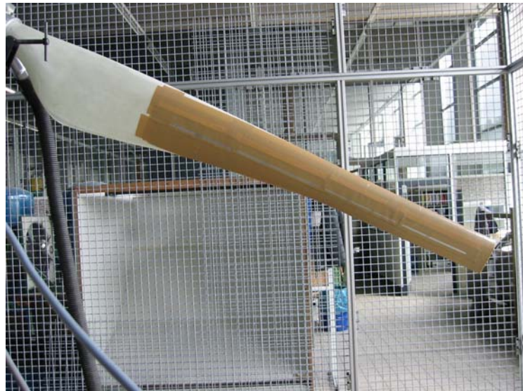
Abb. 9: Bereichsweises Absaugen durch Abkleben verschiedener Flächen (Sektion 4 offen)
