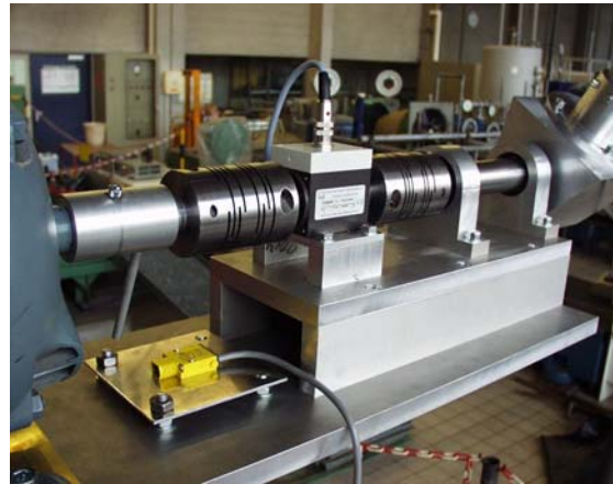
Abb. 7: Antriebsstrang zur Messung der Antriebsleistung (v.l.n.r. Motor; Lichtschranke zur Drehzahlmessung; Drehmomentmesswelle mit zwei Faltenbalgkupplungen; Rotorblatt Halterung)
