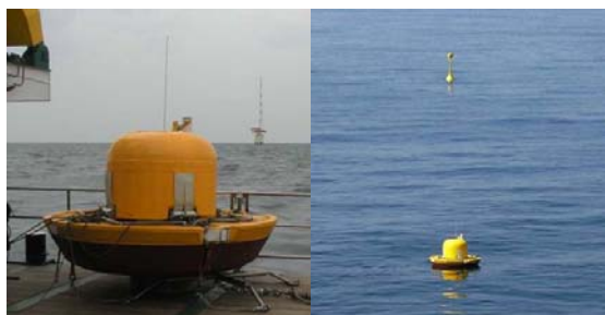
Abb. 5: Die Seegangsboje des BSH vor und nach dem Absetzen in der Nordsee. Die Entfernung zwischen Boje und Plattform beträgt je nach Strömung ca. 300-400m.
