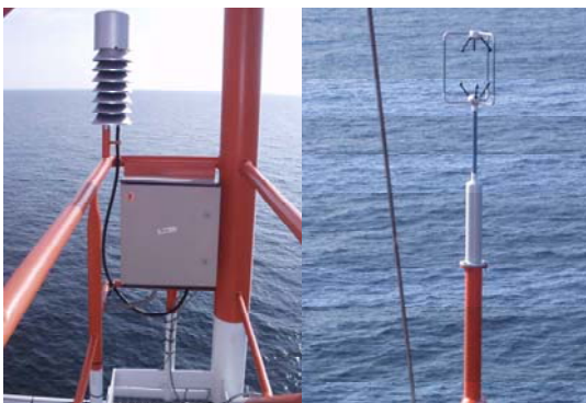
Abb. 3: Sensoren am FINO-Messmast. Links: Thermo- und Hygrosensor mit Schutzhütte. Rechts: Ultraschallanemometer mit einem Teil der Auslegerabspannung.
