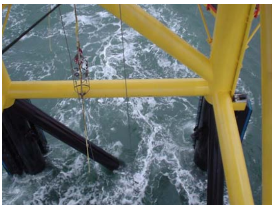
Abb. 6: Die BSH-Messkette wird bei starkem Seegang eingeholt.
