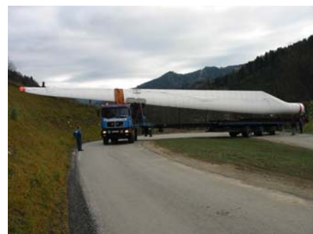
Abb. 5: Transport der Rotorblätter in einer Spitzkehre
