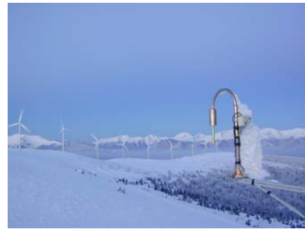
Abb. 9: Eisdetektor mit Blick auf den bereits errichteten Windpark im Hintergrund
