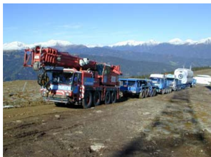
Abb. 7: Bergtransport einer Maschinengondel bei 18% Steigung
