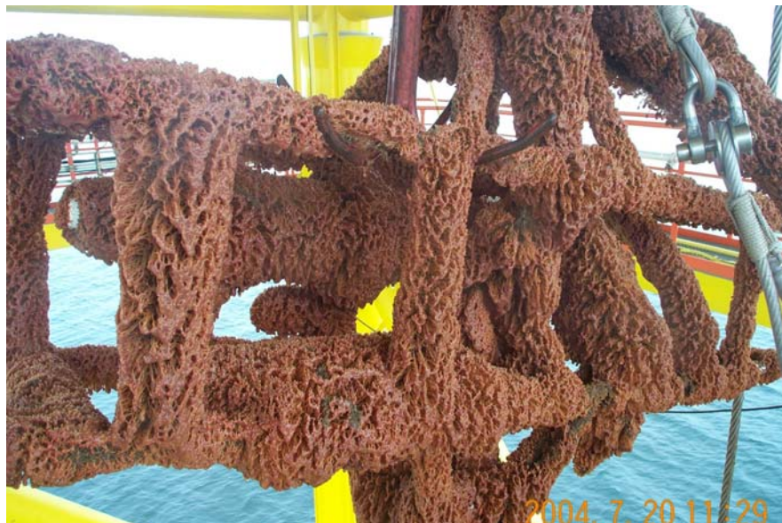
Abb. 4: oberer Messgeräteträger mit starkem Bewuchs durch Hydrozoa. Durch den hohen Wassergehalt ist die Bergung der Messkette erheblich erschwert.
