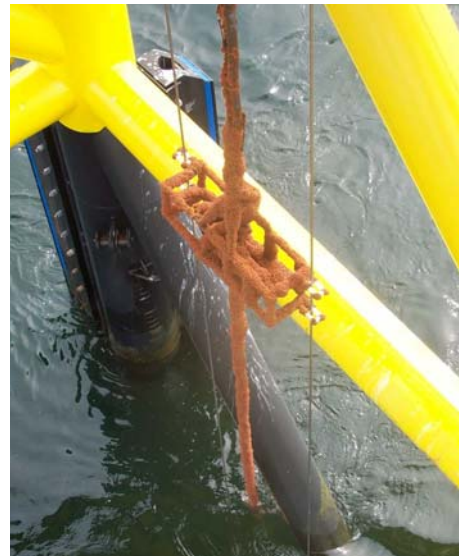
Abb. 3: Messkette mit oberem Geräteträger im Juli 2004, nach sechswöchigem Einsatz in der Hauptbewuchsphase.
