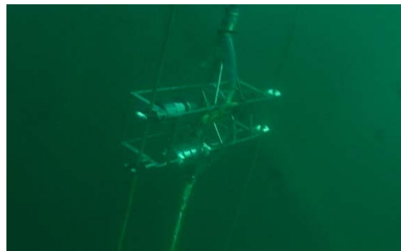
Abb. 2: Messgeräteträger in ca. 6m Tiefe zu Beginn der Wachstumsperiode im April 2004.
