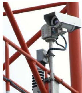
Abb. 4, 5: Wärmebildkamera auf FINO I (linkes Bild) und fliegende Möwen als Wärmebild (rechtes Bild).
