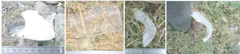
Abb.: 3 Typische Fundstücke in der näheren Umgebung von WEA nach dem Betrieb unter Vereisungsbedingungen. Die Form der Rotorblattnase ist noch deutlich zu sehen.
