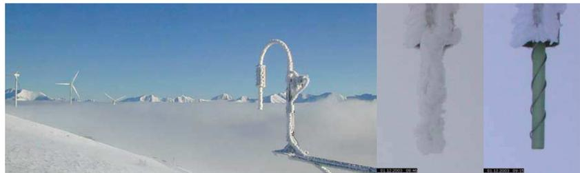
Abb.: 6 Wolkenvereisung verkehrt: Die unteren WEA sind diesmal betroffen. Im Vordergrund und in den Bildern rechts ein Eissensor mit unterschiedlichem Eisansatz und nach dem Abtauen.
