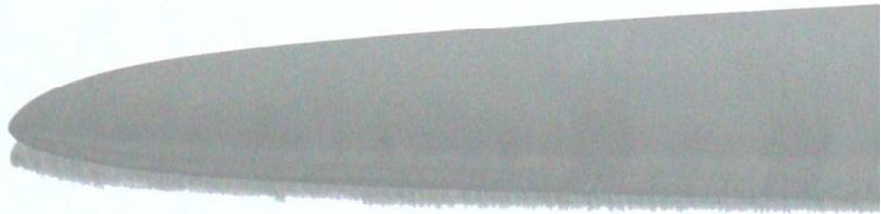
Abb.: 2 Typischer Eisansatz an der Rotorblattnase (Beispiel äußeres Rotorblatt einer 2 MW WEA).
